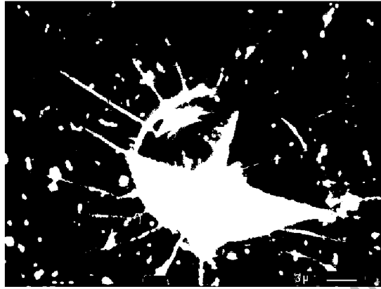
Рисунок 1. Типичная деформационная картина, возникающая на поверхности аморфного сплава у отпечатка пирамиды Виккерса. Снимок сделан с помощью растрового электронного микроскопа Cam Scan-4
