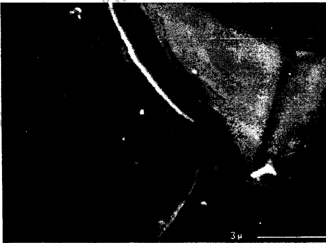
Рис. 1. Деформационная картина, возникающая у отпечатка индентора на поверхности аморфного сплава на основе железа.
