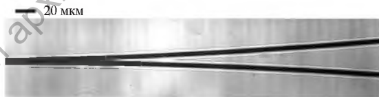
Рис. 5. Фотография волноводного разветвителя 1 \times 2 , сформированного в пленке из полимера PMMA/DO-2 методом лазерного фотоосветления
