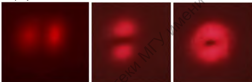
Рис. 3. Наблюдаемое распределение интенсивности: 1) пучка, отводимого одной из граней призмы связи; 2) пучка, отводимого другой гранью призмы и повернутого системой зеркал на 90^\circ ; 3) суперпозиции первого и второго пучков
