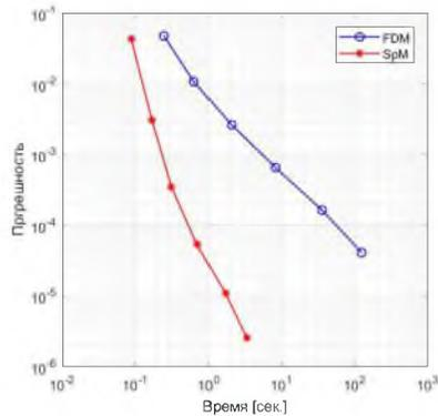
Слева – зависимость коэффициента отражения РОС структуры от отстройки длины волны. Сплошная линия – аналитическая зависимость, пунктирная – зависимость, полученная с помощью разностного метода при  $N = 25$ . Справа – вычислительные затраты для достижения заданной точности для спектрального (SpM) и конечноразностного (FDM) методов
