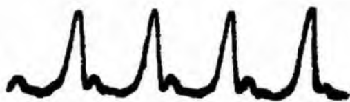
Рис. 7. Оциллограмма излучения гелий-неонового лазера ЛГ-79. Для измерений использован стробоскопический осциллограф С1-74. Период следования импульсов равен 5 нс
