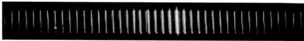
Рис. 20. Спектр оптической частотной гребенки полупроводникового лазера для случая тока накачки несколько превышающего пороговое значение стационарной генерации (35 мА)
