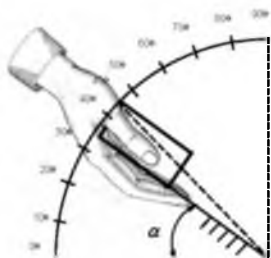
Рис. 2. Схема определения коэффициента трения при покое с помощью наклонной плоскости и момент измерения угла в момент движения металлической пластины
